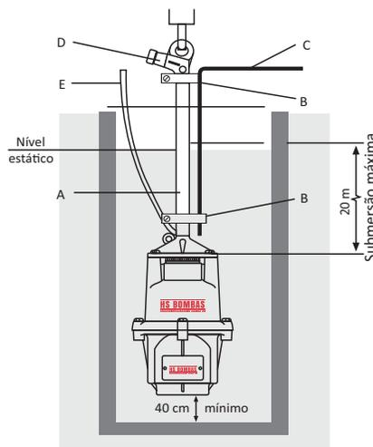
1. A bomba deve ser instalada centralizada entre as paredes do poço ou cisterna, respeitando uma distância mínima de 40 cm do fundo do poço. Trabalhar totalmente submersa e sustentada pela mangueira, observando a submersão máxima de 20 m em relação ao nível estático.
