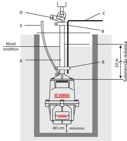
1. A bomba deve ser instalada centralizada entre as paredes do poço ou cisterna, respeitando uma distância mínima de 40 cm do fundo do poço. Trabalhar totalmente submersa e sustentada pela mangueira, observando a submersão máxima de 20 m em relação ao nível estático.
